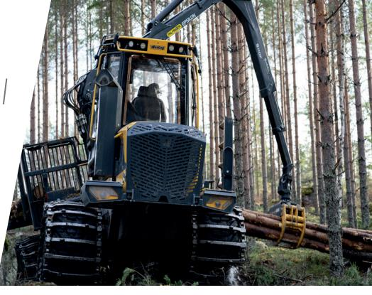
ETC est un système intelligent, ce qui signifie qu'il apprend lui-même et ainsi s'adapte et se développe à mesure que vous l'utilisez. Les capteurs permettent de profiter d'un mouvement et d'un positionnement plus souples et précis de la grue. Le positionnement des capteurs sur la grue permet d'avoir un système robuste et fiable, avec une maintenance rapide et aisée.
